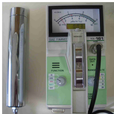
図 1: アロカ株式会社 \gamma サーベイメータ TCS-161
